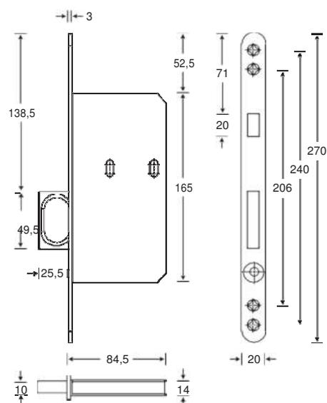
Informazione: la serratura a innesto serie 72 GK per l'uso a porte scorrevoli con anta doppia è disponibile anche separatamente tramite SSF. Per ulteriori informazioni visitate [www.croso.it/ssf](http://www.croso.it/ssf)
